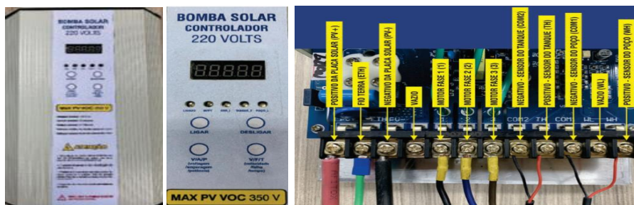
Figura 11: Caixa interface e expliciação da conexão elétrica
